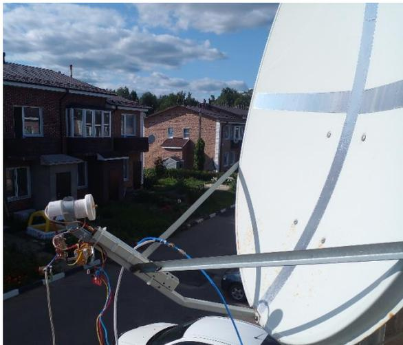
Figure 4. 80 GHz radiometer (2021-2022).
